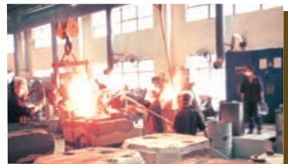
砂鑄生產車間
